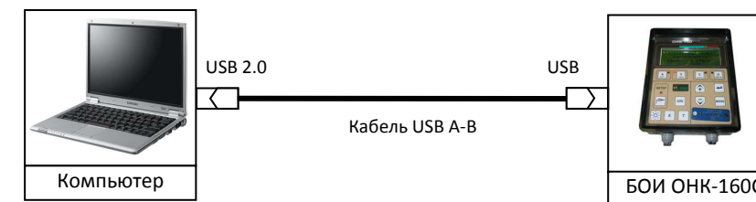
Рисунок 7. Подключение РП ОНК-160С.
