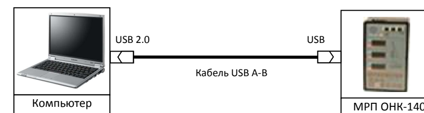
Рисунок 8. Подключение МРП ОНК-140.
